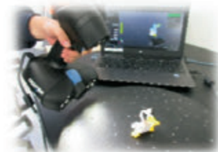
製品の3次元形状をデータ化するスキャナ
